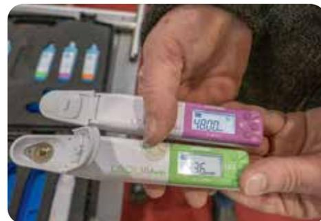
Analysegerät LAQUAtwin die Stickstoff- oder Kaliumgehalte bestimmt. Der Wert wird in der App eingetragen, wo die Datenbank Optimal-Werte von 75 verschiedenen Pflanzenarten in unterschiedlichen Entwicklungsstadien für den Vergleich führt. Das erlaubt die Bestimmung des aktuellen Standes der Nährstoffversorgung im Pflanzenbestand und ermöglicht es, einer Unter- oder Überversorgung und damit einer Qualitäts- und Ertrageinbusse entgegenzuwirken. ■
