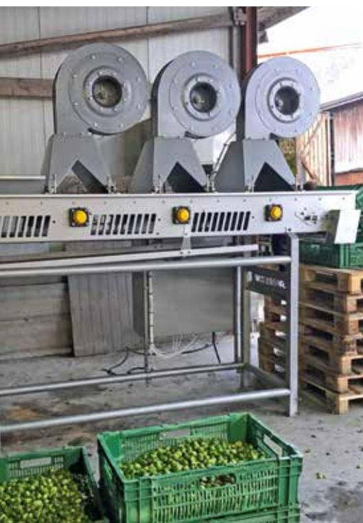
Das Legunet (NKG) unterstützt ein Projekt mit Massnahmen zur Verbesserung der Rosenkohl-Qualität: etwa eine Entwässerungseinheit mit drei Gebläsen und dem Förderband.
